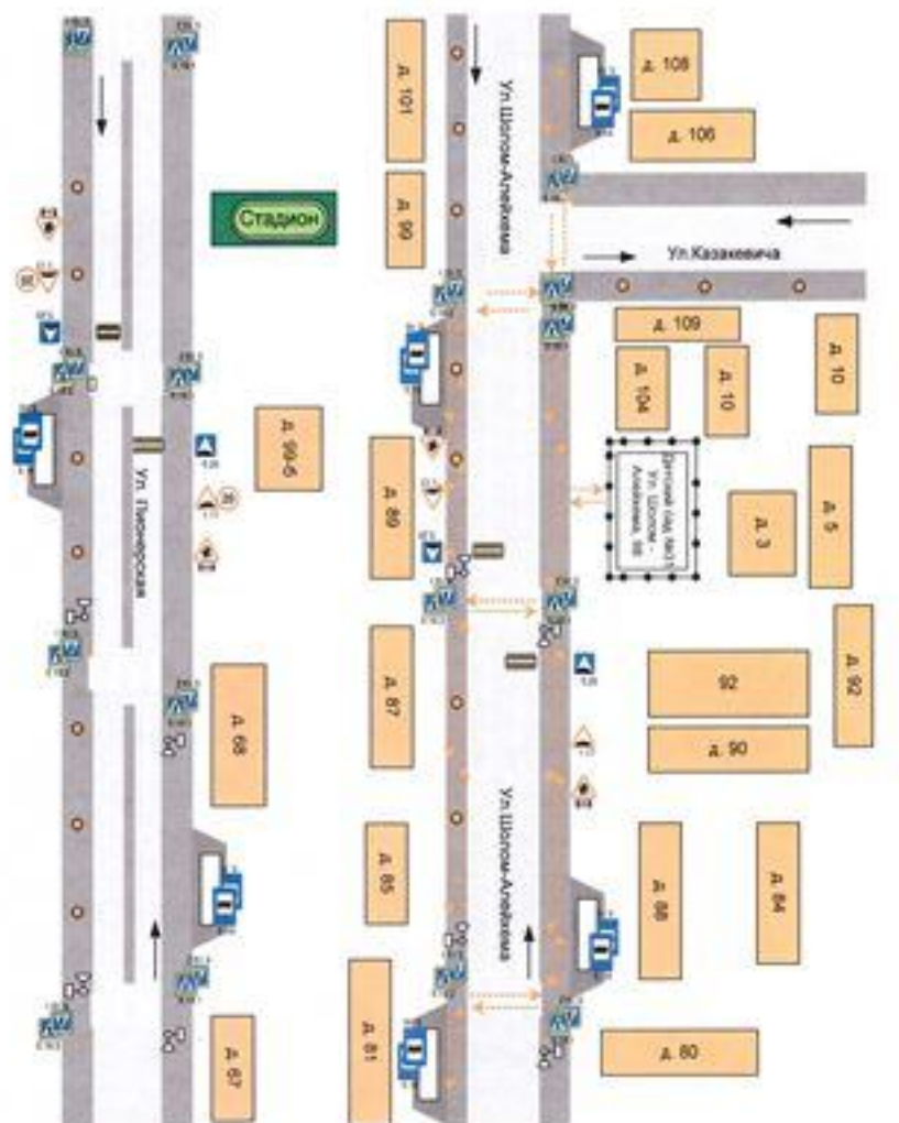
Схема организации дорожного движения в непосредственной близости от образовательного учреждения с размещением соответствующих технических средств, маршруты движения детей и расположение парковочных мест
